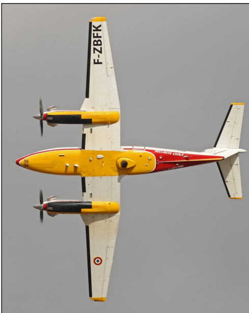
▲ Bengale 96 nous montre ses nouvelles installations de communication et sa boule FLIR Star SAFIRE 380-HDc. Deux Beech 200 sont ainsi équipés pour la supervision des feux de forêts.
