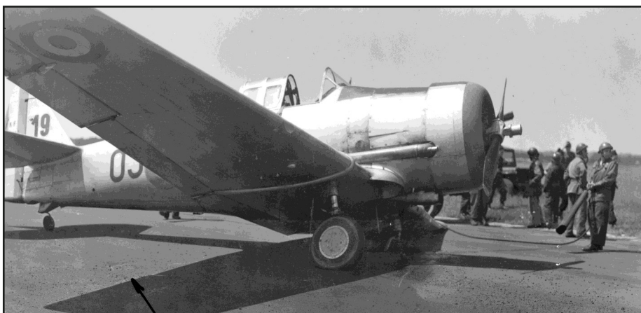
▲ ▼ Le 4 août 1953, le S/Lt Lempereur et son passager, le CC Couedens ramènent l'AT-16 KF597 dont la 33 e ERT n'a plus d'utilité, de Cognac à Cazaux. L'atterrissage de ce vol qui aurait dû être tranquille ne se passe pas comme prévu. Cette vue permet de montrer une caractéristique des AT-16 et autres Harvard fabriqués au Canada, le pot d'échappement long dans lequel passe un tuyau permettant la prise d'air extérieur qui passant dans les gaz brûlés se réchauffe et permet d'améliorer un peu la température intérieure de l'avion. (BE 706).
