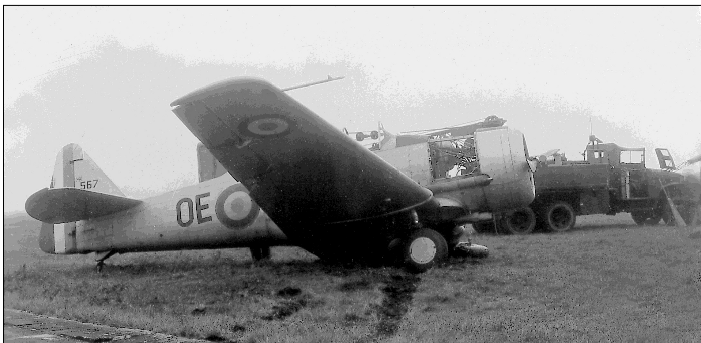
▲ Le KF567 F-TEOE victime d'une sortie de piste suivie d'un train fauché, un symptôme classique des accidents d'AT-16 dans l'armée de l'Air. DR via Alain Crosnier.
