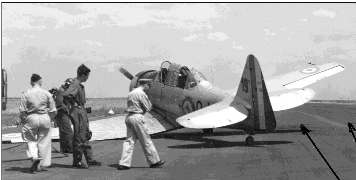
▲ ▼ Le 4 août 1953, le S/Lt Lempereur et son passager, le CC Couedens ramènent l'AT-16 KF597 dont la 33 e ERT n'a plus d'utilité, de Cognac à Cazaux. L'atterrissage de ce vol qui aurait dû être tranquille ne se passe pas comme prévu. Cette vue permet de montrer une caractéristique des AT-16 et autres Harvard fabriqués au Canada, le pot d'échappement long dans lequel passe un tuyau permettant la prise d'air extérieur qui passant dans les gaz brûlés se réchauffe et permet d'améliorer un peu la température intérieure de l'avion. (BE 706).
