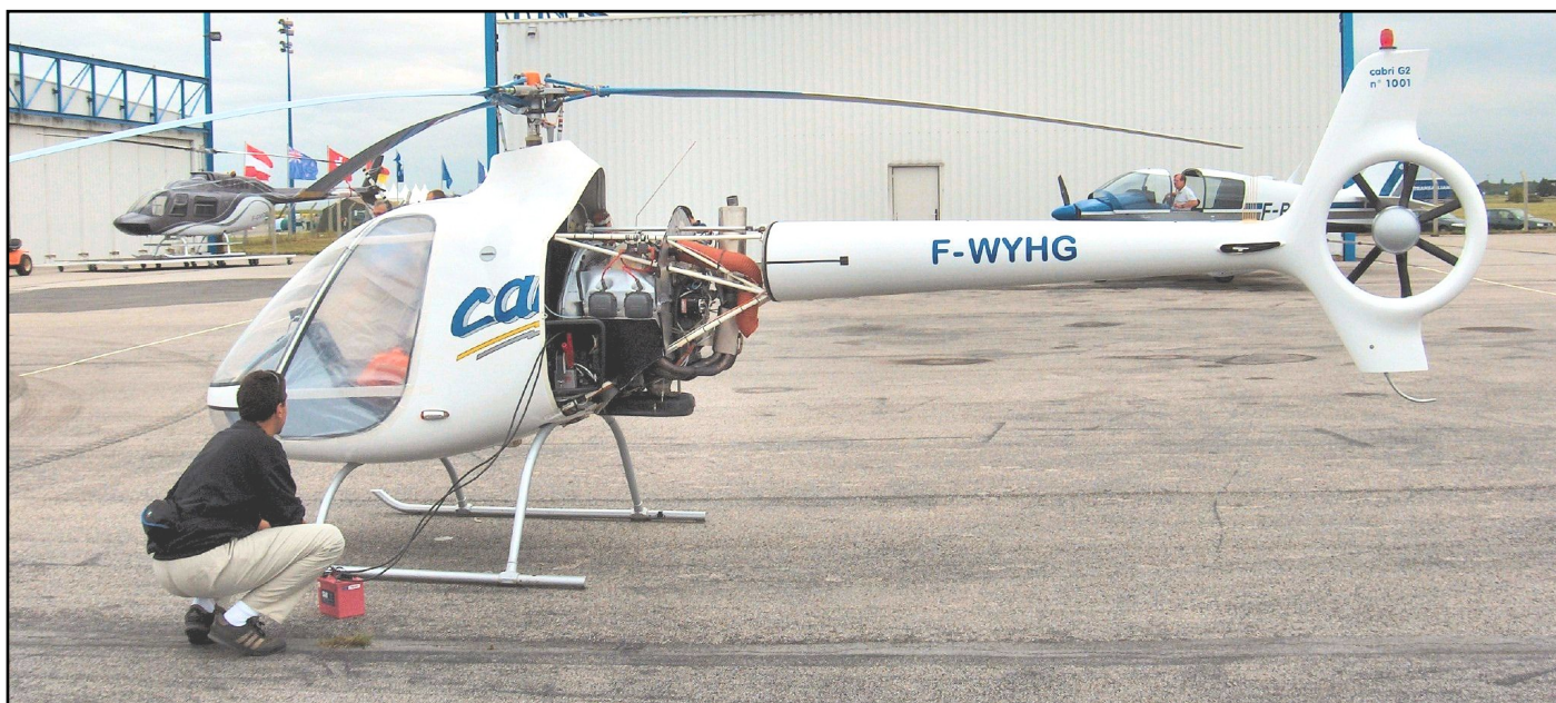
Juste avant le démarrage. Lionel Pignier vient de raccorder la batterie de 25 kVA. On voit bien les allégements. Portes "filmées", capots et plan fixe déposés.
